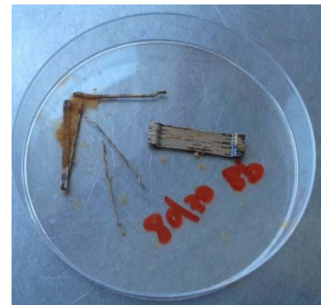
Fibre corrodibili, prova non superata
