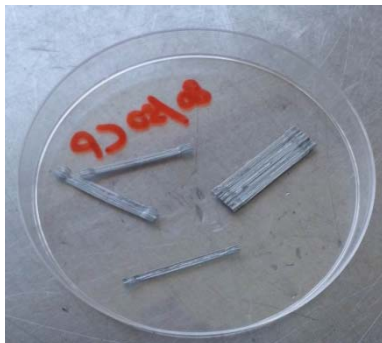
Fibre anticorrosione, prova superata
